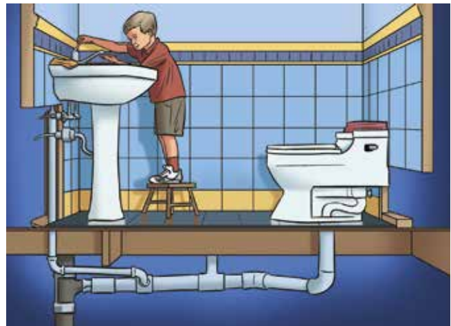
Закрытый способ прокладки
