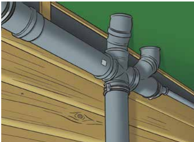
Открытый способ прокладки
